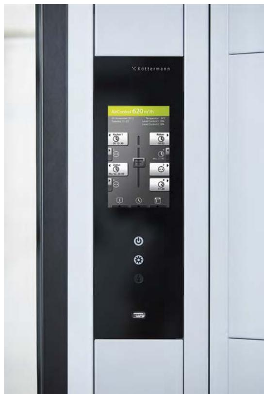
**Bild 8.** Per Schieberegler auf dem Touchscreen lässt sich der Frontschieber bedienen
