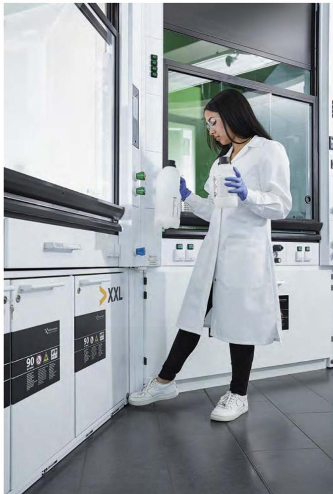
**Bild 9.** Der Fußtaster ermöglicht auch bei vollen Händen, den Frontschieber zu öffnen oder zu schließen (Fotos: Köttermann GmbH)
